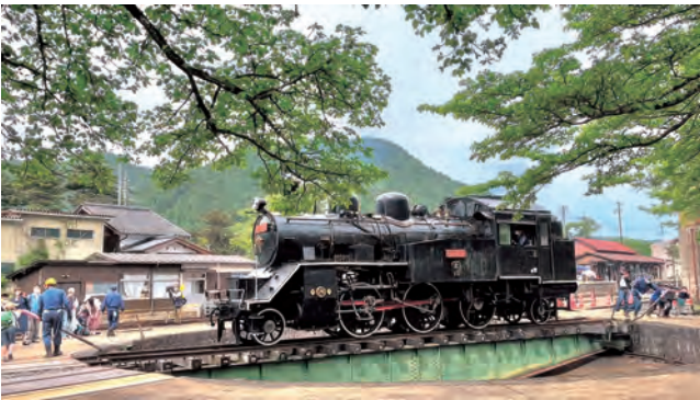
▲SLの乗った転車台を力いっぱい回します。SLの重量は40トンありますが、意外と軽く回すことができます
