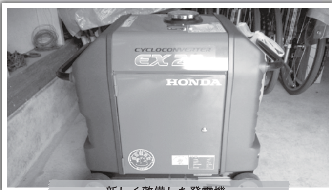
新しく整備した発電機
