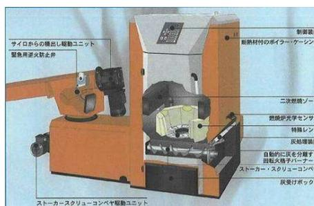
図 UTSLシリーズボイラの内部構造
