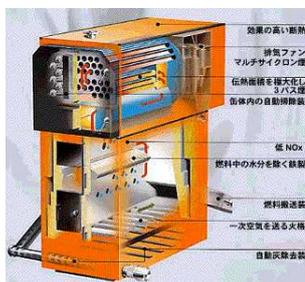
図 UTSRシリーズボイラの内部構造
